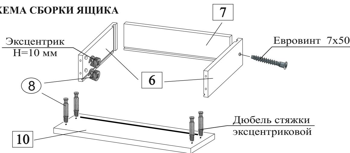
В накладку ящика вворачивается дюбель эксцентриковой стяжки. Ящик собирается согласно схеме: 1 боковая и задняя стенки ящика стягиваются евровинтом 7x50, в паз вставляется дно, крепим вторую боковую стенку, накладка стягивается с корпусом ящика.
