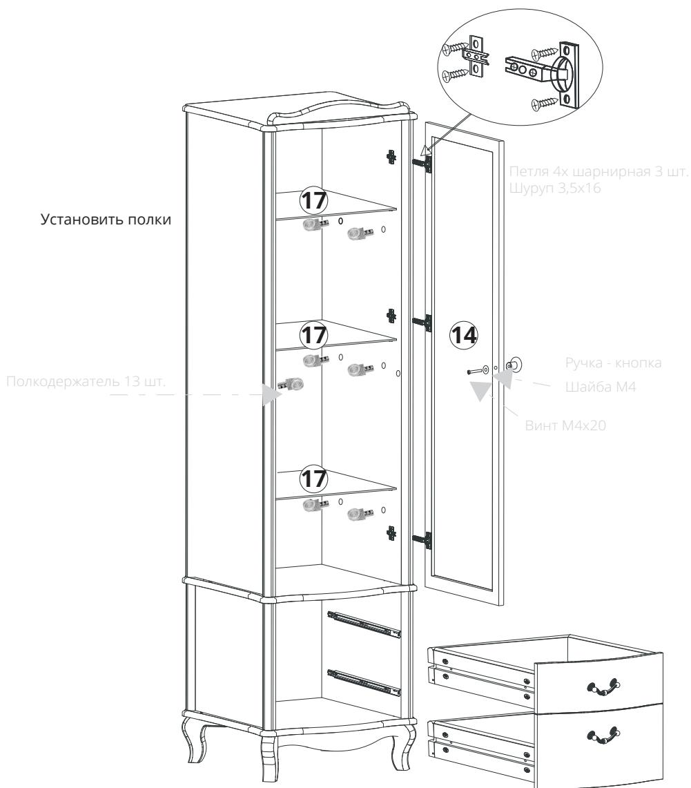
**Схема регулировки петли**
