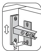
Винт для регулировки
