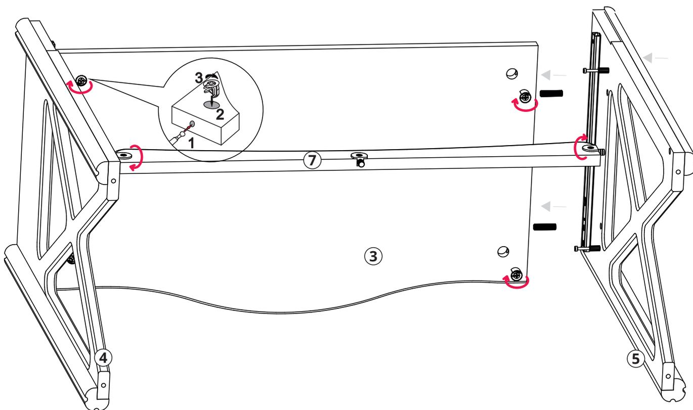
В горизонтальную стенку **3** вставить направляющие шканты 4 шт. Боковину **5** используя направляющие шканты состыковать с горизонтальной стенкой **3** и зафиксировать эксцентриками 2 шт. Присоединить царгу **7** к боковине **5** с помощью стяжки Quickloc как показано на рисунке. С боковиной **4** проделать аналогичные действия.
