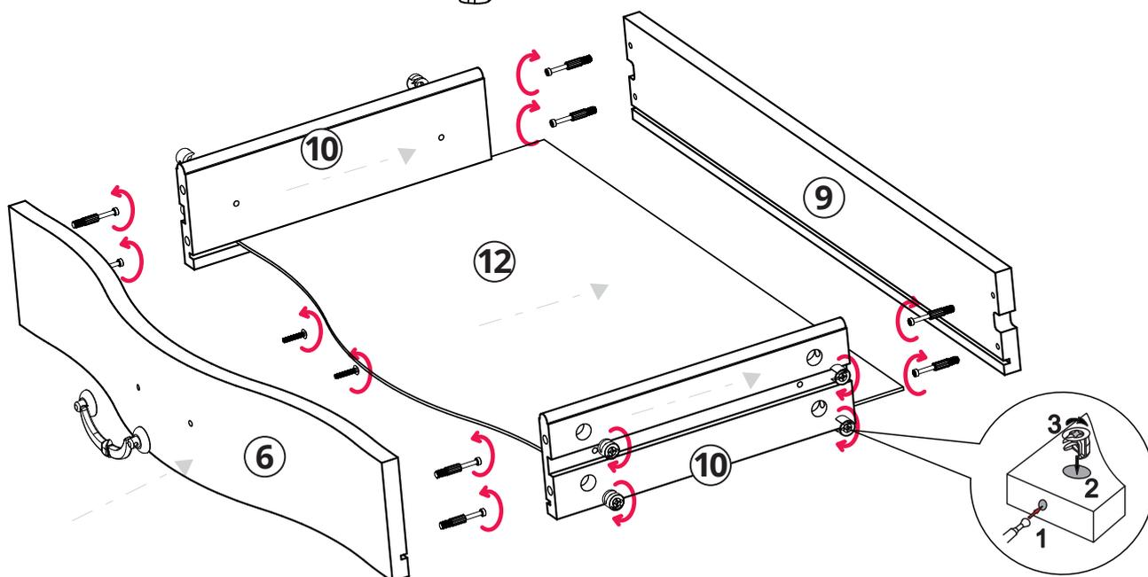
Ввернуть штоки эксцентриковых стяжек в детали **6** и **9**. Боковины **10** закрепить на детали **9** при помощи эксцентриков. Вставить деталь **12** в пазы. Деталь **6** закрепить на деталях **10** при помощи эксцентриков. Привернуть ручку.
