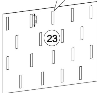
Обезжирить обратную сторону зеркала и ЛДСП, на которую крепится стекло /спирт, ацетон/. Отступить от краев стекла по 20мм, наклеить 2-х сторонний скотч клейкой стороной на обратную сторону зеркала по указанной схеме, снять защитную пленку со скотча на зеркале, затем выровнять зеркало относительно ЛДСП в вертикальном положении и плотно прижать зеркало к поверхности (см.рисунок)
