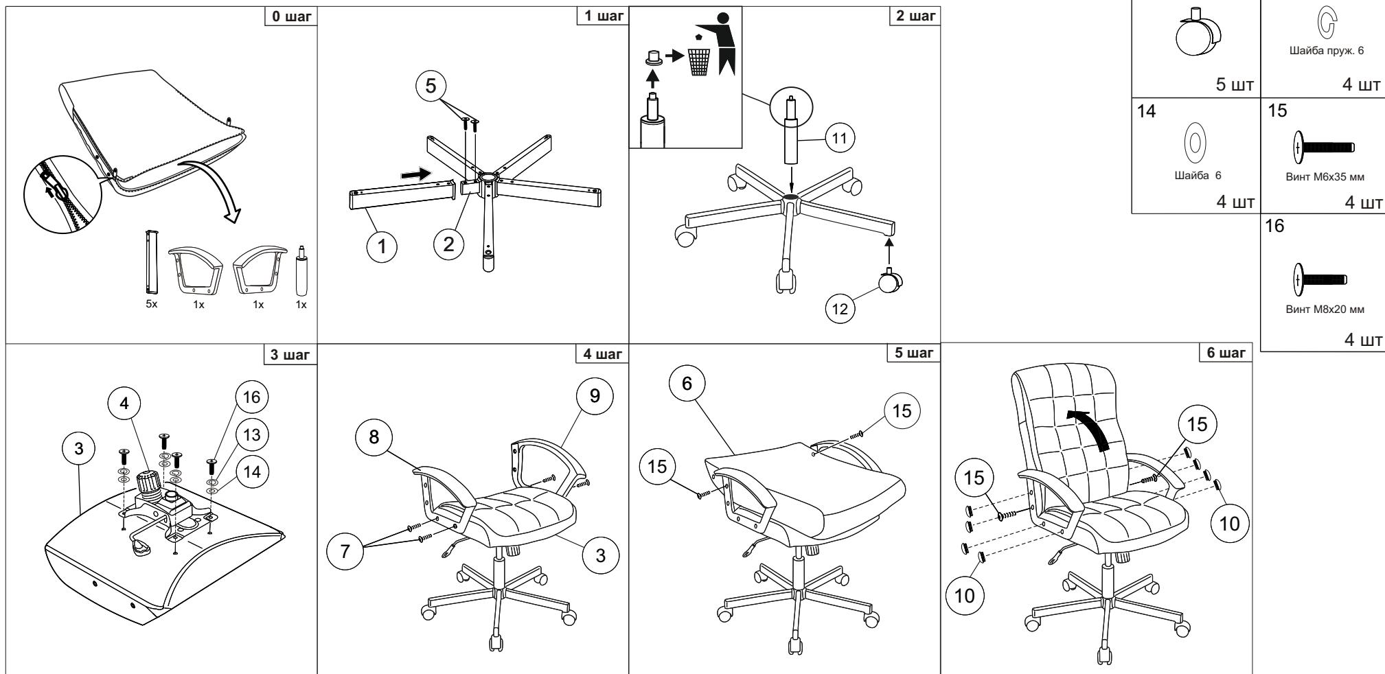
**Примечание:** Шаг 2. Снять защитный колпачок с газлифта, в случае его наличия.
